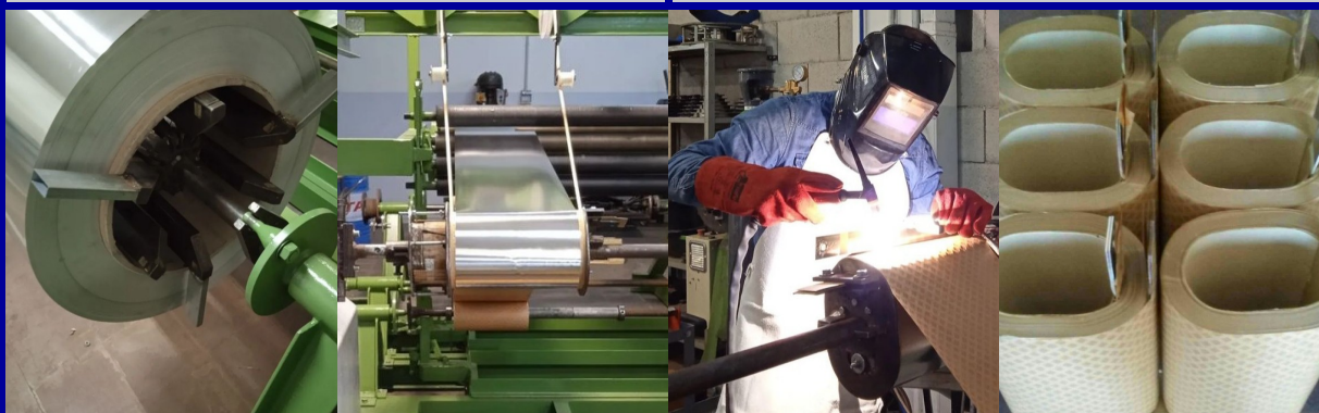
Avvolgimenti BT per trasformatori di distribuzione in olio installati su rete ENEL
